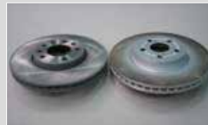
Bremsscheibe lackiert mit Zinkstaubfarbe oder Geomet®
