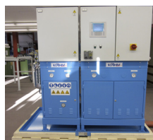
Fünf neue Begasungsgeräte machen es möglich, ca. 35 Tonnen Amingas pro Jahr einzusparen
