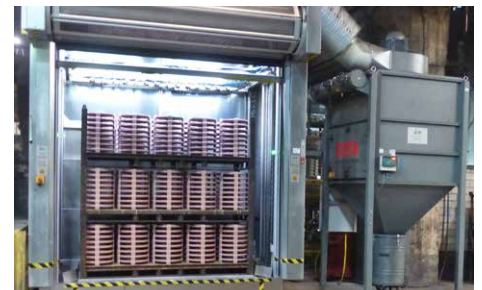
Innovation in Eigenentwicklung: Die neue Kernreinigungsanlage
