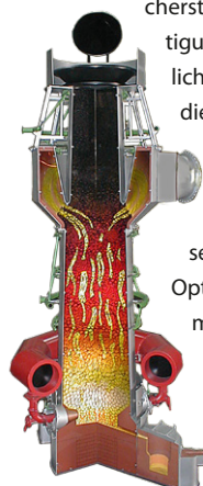
Schnittbild des futterlosen Heißwind-Kupolofens; Höhe: 18 Meter, mittlerer Durchmesser: 2,6 Meter
