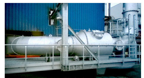
Der neue Grobstaubabscheider sorgt für die Reduzierung der Reinigungskosten an Brennkammer und Entstaubung und steigert die Schmelzleistung des Kupolofens
