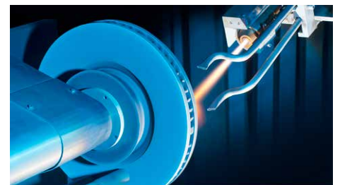
Die Hartmetallbeschichtung wird im Flammstrahlverfahren auf den Reibring aufgebracht
